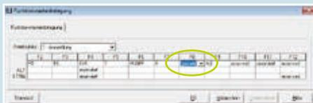
Um einen Job auf einer Funktionstaste zu hinterlegen wählen Sie `System > Weiteres > Konfiguration Funktionstasten`. Unter der gewünschten Funktionstaste hinterlegen Sie die Funktion über die Eingabe `.Jobname` (hier: `.gesund`) und speichern mit `OK`.
